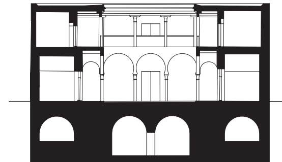
Coupe de principe du dār, la citerne sous le patio, et les caves sous les pièces à vivre.
