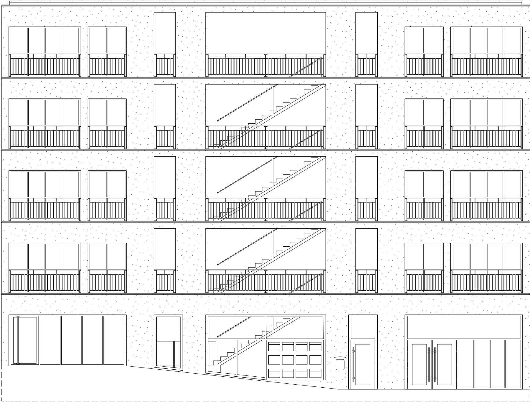
élévation façade nord 1:100
